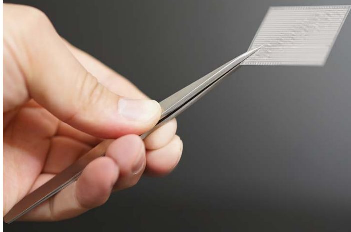
40 µm piezoelektrisk element
