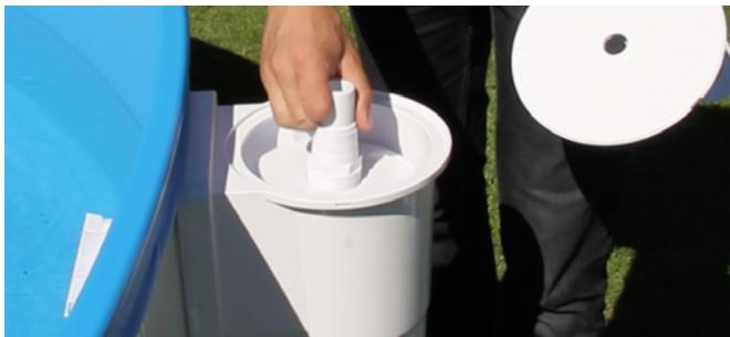
Die Saugplatte (6) des Skimmers ermöglicht, einen Schlauch an die Filteranlage anzuschließen, wenn der Poolboden abgesaugt werden soll. Der Poolschlauch wird mit dem mitgelieferten Ellbogen-Schlauchstutzen (7) an der Saugplatte montiert.
