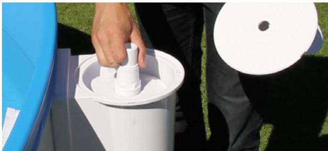
Oppsamlerens sugeplate (6) gjør det mulig å montere en slange på filteranlegget når bassengbunnen skal støvsuges. Bassengslangen monteres på sugeplaten ved hjelp av den vinklede slangestussen som følger med (7).
